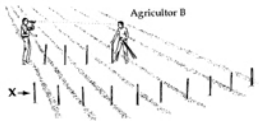
Figura 21. Marcación de la curva de nivel
