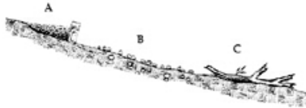
Figura 1. Señales de erosión laminar
